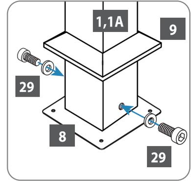
Lassen Sie die Stützgerüste (9) ca. 25 cm über dem unteren Ende der Pfosten (1/1A) bis zu Schritt 4.
