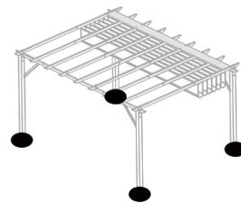
Befestigen Sie den Gazeborahmen am Boden, indem Sie die Erdhaken (21) für jede Stützplatte verwenden. Senken Sie den Stützrahmen (9) um die Stützplatte (8) abzudecken.
