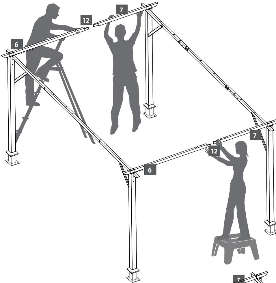
Befestigen Sie danach das Grundgerüst mit den Schrauben (23).
