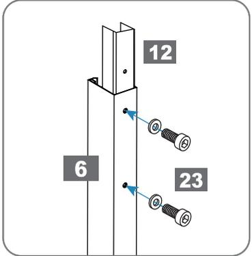
Führen Sie den langen Querträger (6) durch die Pfostenverbinder (15), sodass Sie den Querträger mithilfe der vorgesehenen Löcher mit den Schrauben (23) befestigen können.
