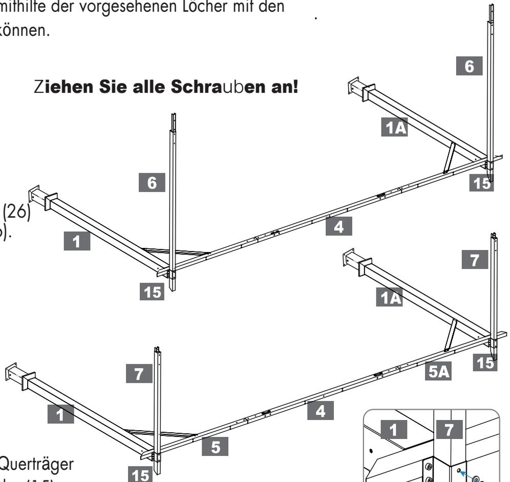
Führen Sie nun die kurzen Querträger (7) durch die Pfostenverbinder (15), sodass Sie den Querträger mithilfe der vorgesehenen Löcher mit den Schrauben (23) verbinden können.
